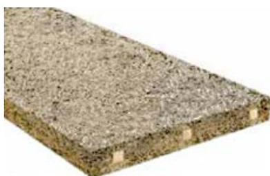
Применяются усиленные плиты, армированные деревянными рейками. Плиты не только являются конструкционным элементом, выдерживающим снеговую нагрузку, но и выполняют роль утеплителя и звукоизолятора при толщине 100 мм. Повышенные показатели огнестойкости материала дают возможность кровельщикам наплавливать рулонные материалы на плиту с помощью открытого огня.
